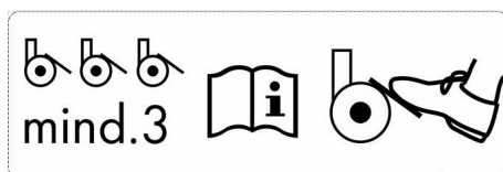
Partea C: Fig.1: Frânarea rotelor de rulare
