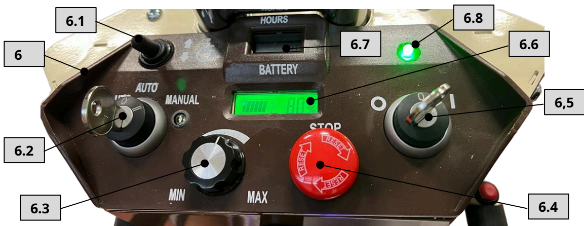
Figura 4-3: Panou de control
